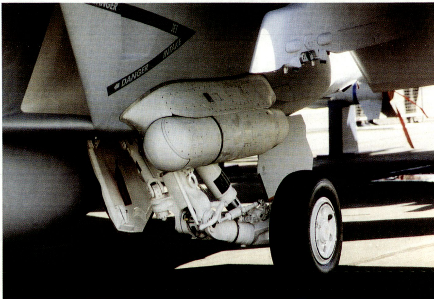
Linkes Haupttradbein mit Raytheon Advanced Targeting Forward Looking Infra-Red (ATFLIR) system.
