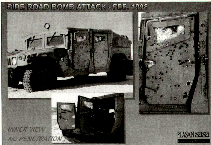
Abb. 1: Geländefahrzeug «Hummer» mit beschusssicherer Zusatzpanzerung.
