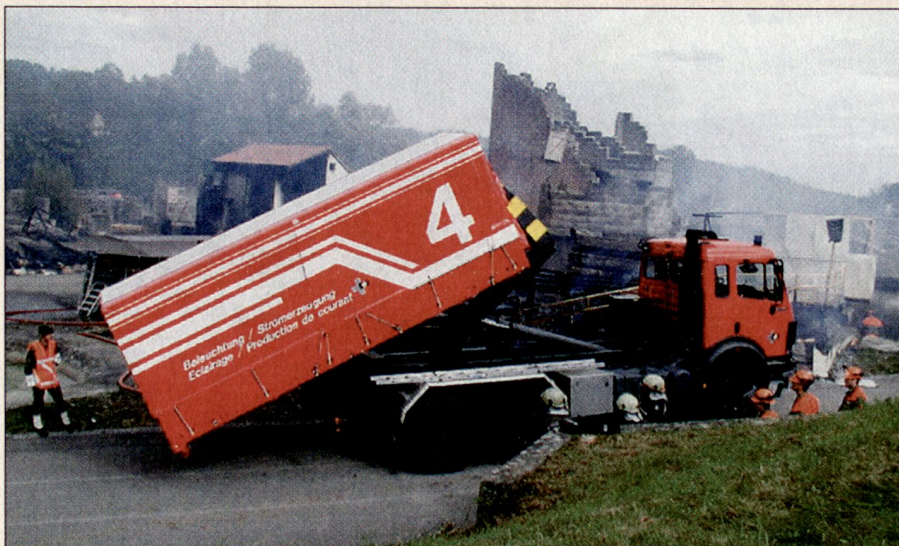
Trägerfahrzeug WELAB mit WELAB Nr. 4 (Beleuchtung/ Stromerzeugung) des Kata Hi Bat resp. der Kata Hi Ber Kp.
