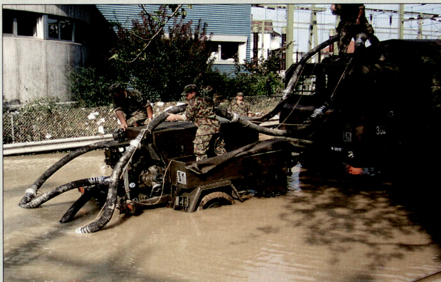
Löschwasserpumpen im Einsatz.
