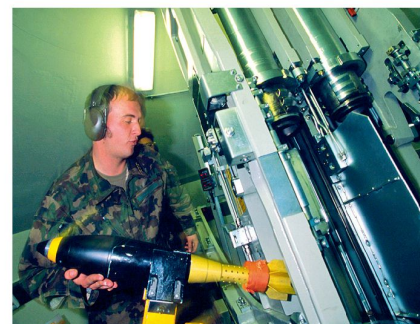
Ladevorgang eines 12 cm Festungsminenwerfers.
