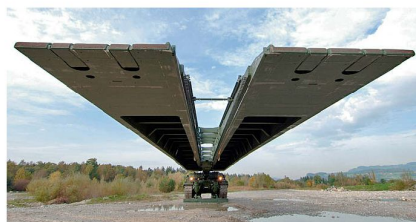
Der Brückenlegepanzer als RUAG Wegbereiter.
