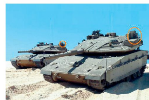
Kampfpanzer «Merkava IV» ausgerüstet mit aktivem Schutzsystem. Bild: Rafael
