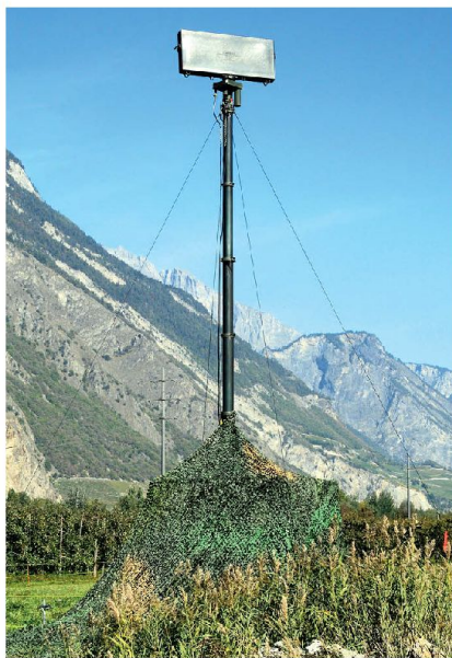
Die Alarm Syst STI dienen primär der Alarmierung der Feueinheiten. Sie können auch einen Beitrag zum erkannten Luftlagebild der LW leisten. Bilder: LVb Flab 33
