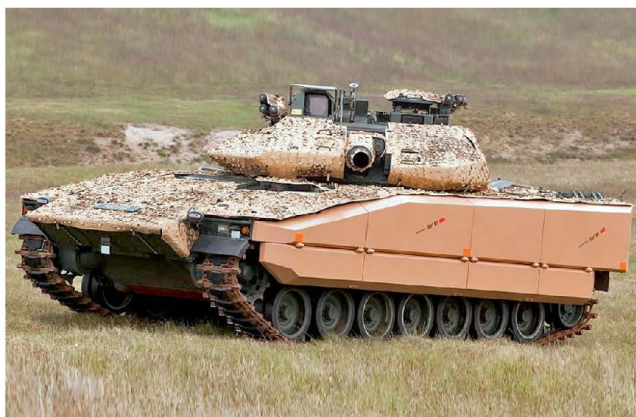
Schwedischer Schützenpanzer CV9040 mit neuem Schutzkonzept.
