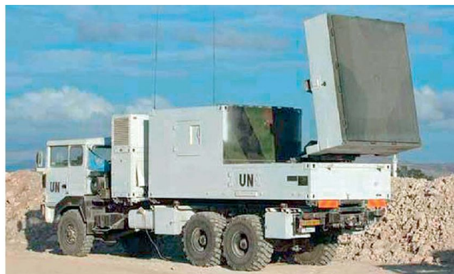
Artillerieradar «Cobra» zum Schutz vor feindlichem Beschuss.
