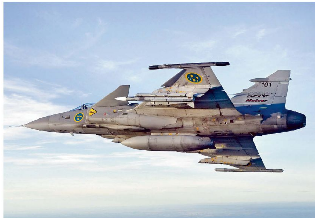
Kampfflugzeug JAS-39 «Gripen» mit Luft-Luft Lenkwaffe «Meteor».
