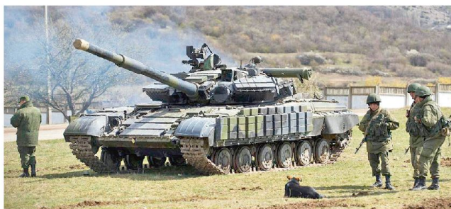
Kampfpanzer T-64BV, ausgerüstet mit 125-mm-Kanone und Reaktivpanzerung. Bild: UKR mil photos
