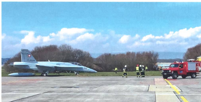
Bergungsübung mit eingeknicktem Fahrwerk und verlorenem Runt. Bild: VBS
