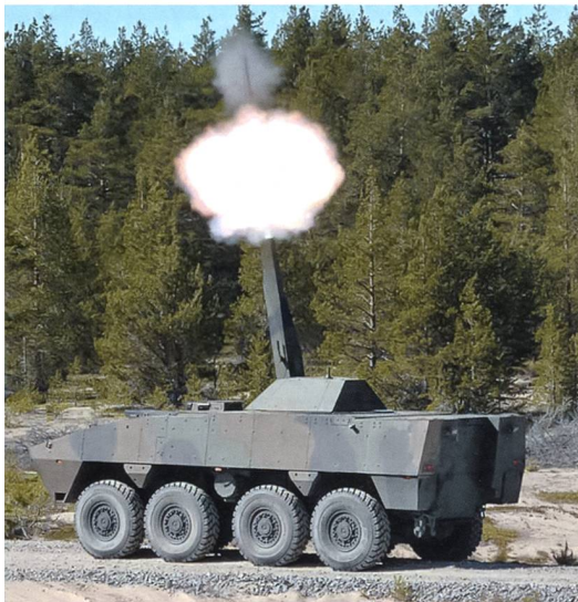
Die Beschaffung eines 120 mm Mörsers ist geplant (hier Patria AMV 8x8 mit Nemo 120 mm mortar system). Bild: Patria
