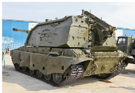
Modernisierte Panzerhaubitze 152 mm 2S33 «Msta-SM» ausgerüstet mit Ladehilfe hinten am Turm.
