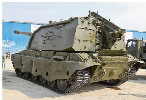
Modernisierte Panzerhaubitze 152 mm 2S33 «Msta-SM» ausgerüstet mit Ladehilfe hinten am Turm.
