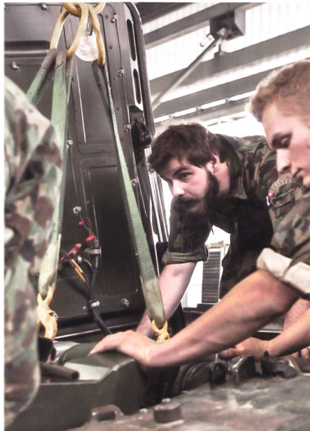
Volle Konzentration beim Einbau der Antriebsgruppe in den Panzer LEO.
