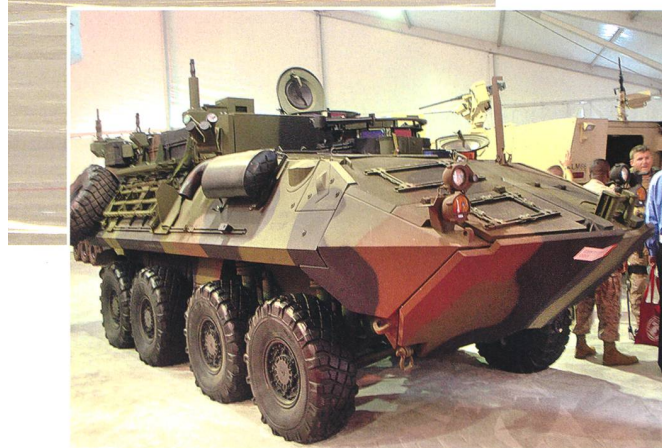
Achtrad LAV (Light Armoured Vehicles), basierend auf einem Mowag Produkt, gehören zur Standardausrüstung einer Marine Expeditionary Unit (MEU).
