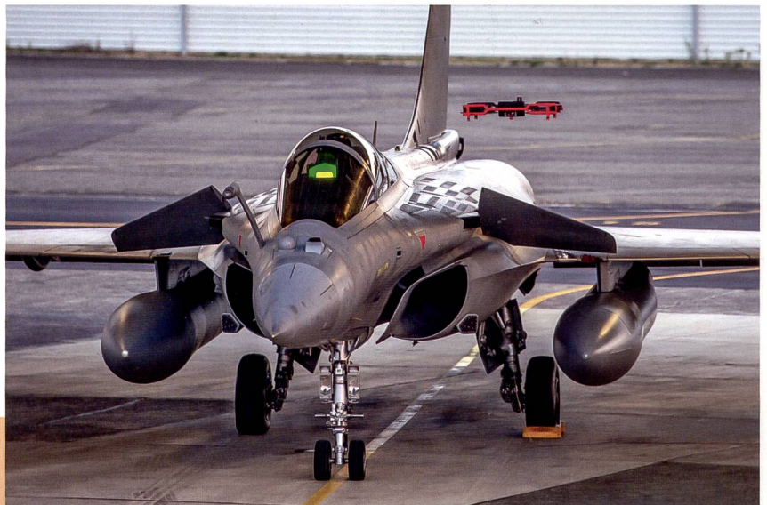
Preflight-Check mit Unterstützung durch eine Drohne.
