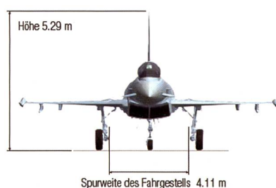
Hauptabmessungen des Eurofighter.
