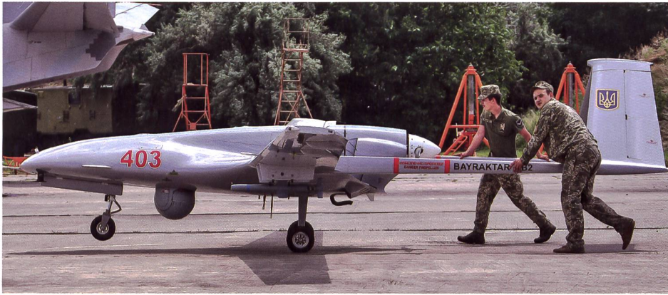
Eine mit einer MAM-C beladene ukrainische TB2. Diese ist aufgrund ihrer geringen Grösse und Geschwindigkeit von den Radarsystemen nur schwer zu orten. Quelle: www.oryxspioenkop.com
