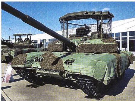
Russischer Kampfpanzer T-90M mit Drohnenschutzgitter und mehrschichtigem Schutz- und Tarnsystem. Bild: Iswestija
