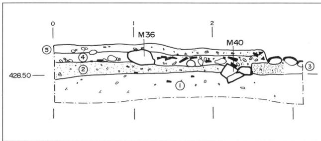
**Abb. 28** Solothurn/Dornacherplatz. Nordprofil P28. **1** gewachsener Lehm. **2** Bauhorizont, Haus 16./17. Jh. **M40** Mauer älterer Anbau. **3** Pflaster im Osten (älterer Anbau). **4** Schutt älterer Anbau. **M36** Mauer jüngerer Anbau. **5** Schutt jüngerer Anbau.
