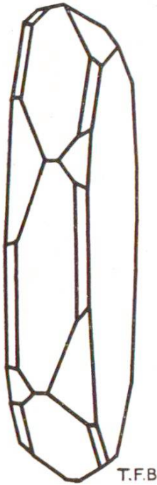
Fig. 4 Cristal idéal d'hématite, oxyde de fer que l'on trouve aussi dans le ciment
