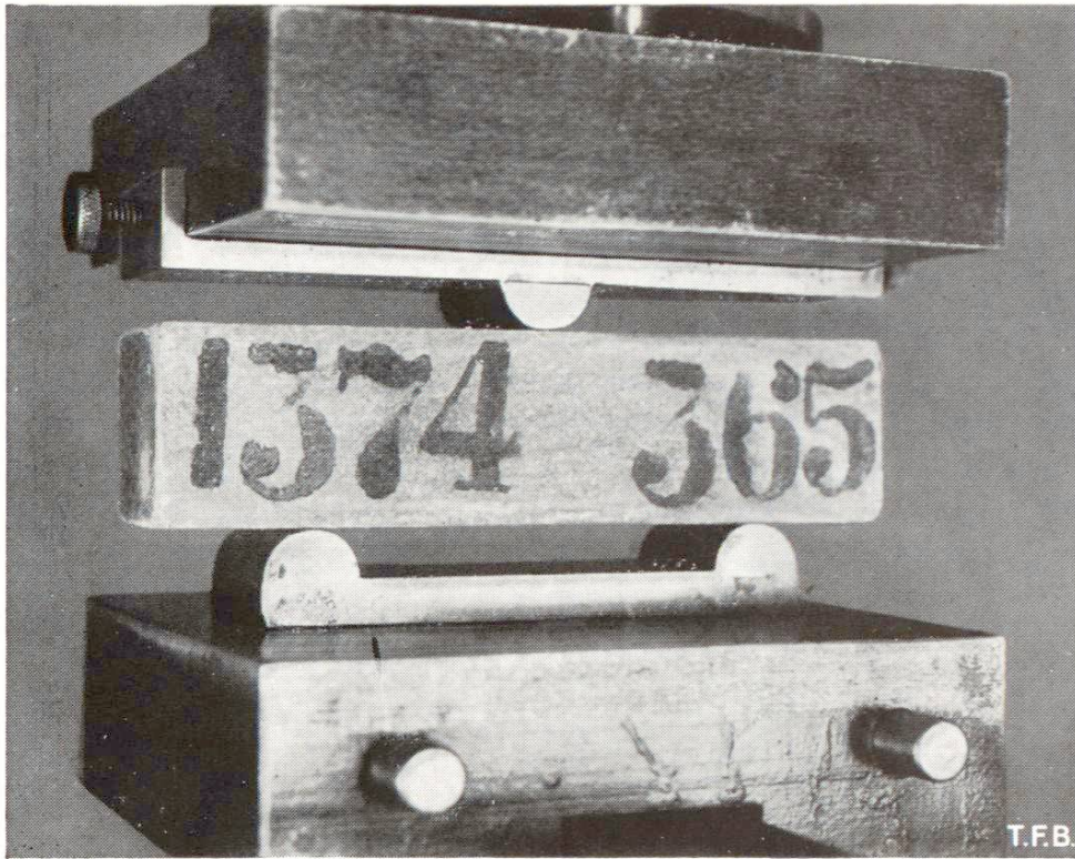
Fig. 4 Prisme de mortier normal ( 4 \times 4 \times 16 cm) soumis à l'essai de flexion. Après la rupture du prisme, les deux moitiés restantes sont encore soumises à l'essai de résistance à la compression
