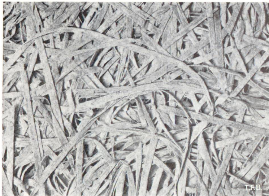
Fig. 3 Vue d'un panneau à fibres de bois liées au ciment
