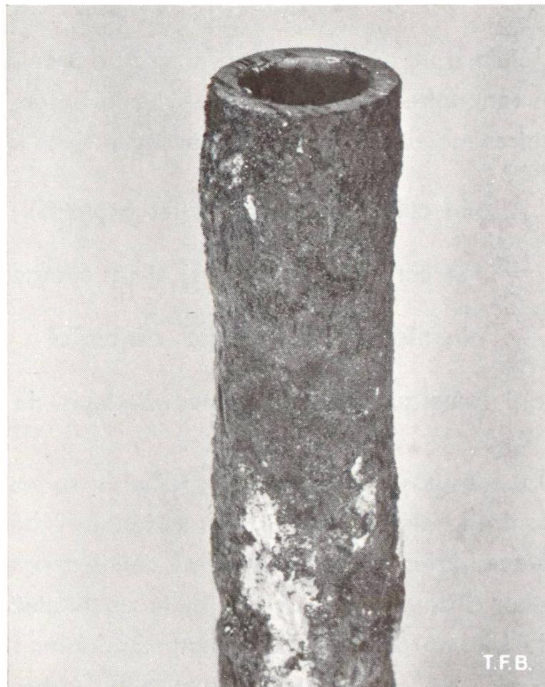
Fig. 3 Corrosion d'un tuyau en plomb provoquée par le mortier avoisinant. L'attaque progressive ressort des différentes colorations des couches d'oxyde (oxydes de plomb jaunes et rouges)
