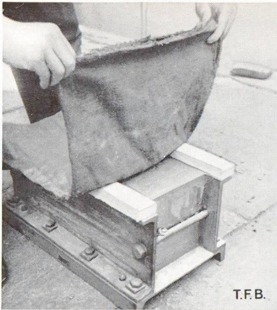
Fig. 13 Protection du béton, avant démou-
