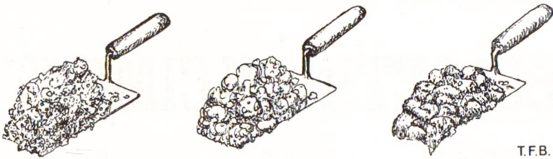
Fig. 1 Béton terre humide, faiblement plastique et plastique soumis à l'essai de la truelle
