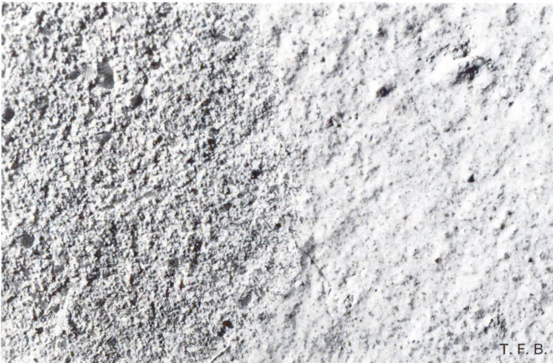
Fig. 5 Vue microscopique d'une surface traitée à l'acide comme à la figure 4. A la partie gauche de la photo, il manque environ 2 mg de \text{CaCO}_3 par \text{cm}^2 .
