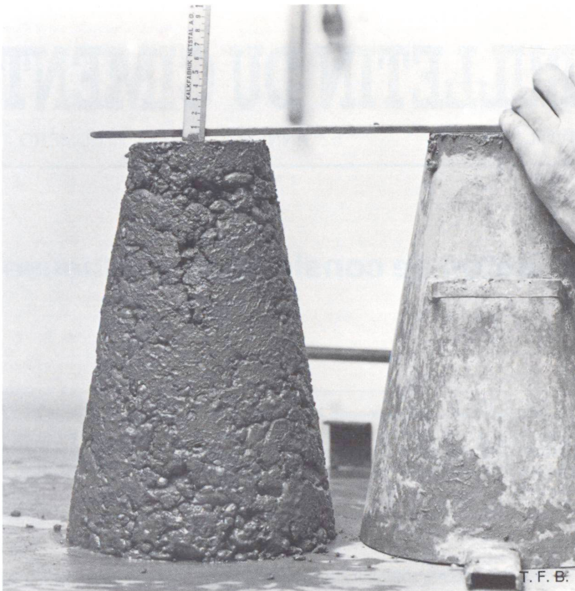
Fig. 1 Mesure d'affaissement (slump) d'un béton raide, pauvre en sable. On remarque la tendance au démêlage et au manque de compacité, préjudiciable à la durabilité.
