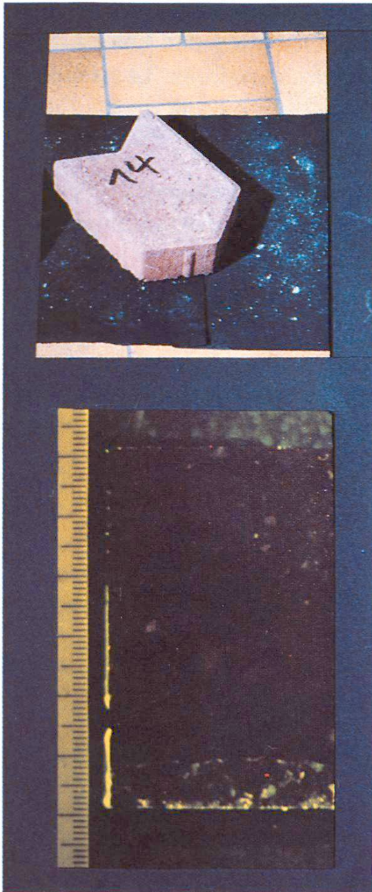
Fig. 4 Pavé sans efflorescences. Coefficient d'absorption capillaire B = 10 \cdot 10^{-3} \text{ m h}^{-0,5} .
