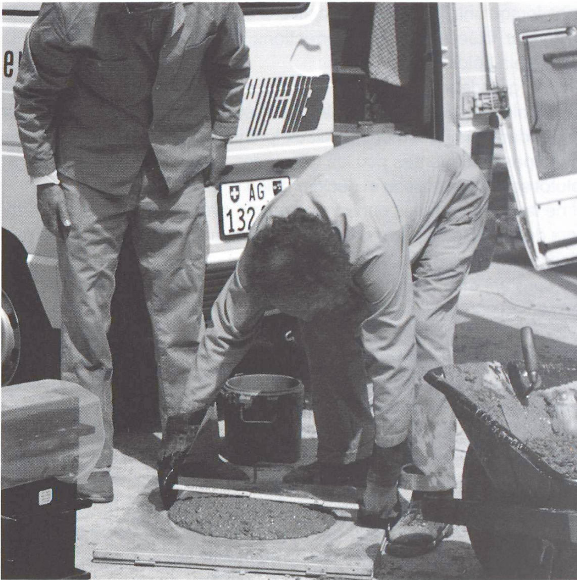
La détermination de la mesure d'étalement.
