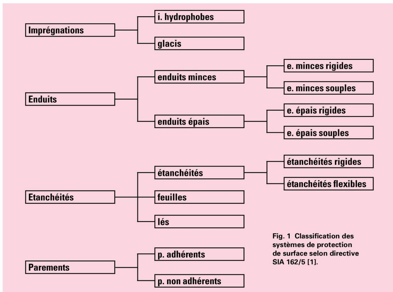
Fig. 1 Classification des systèmes de protection de surface selon directive SIA 162/5 [1].
