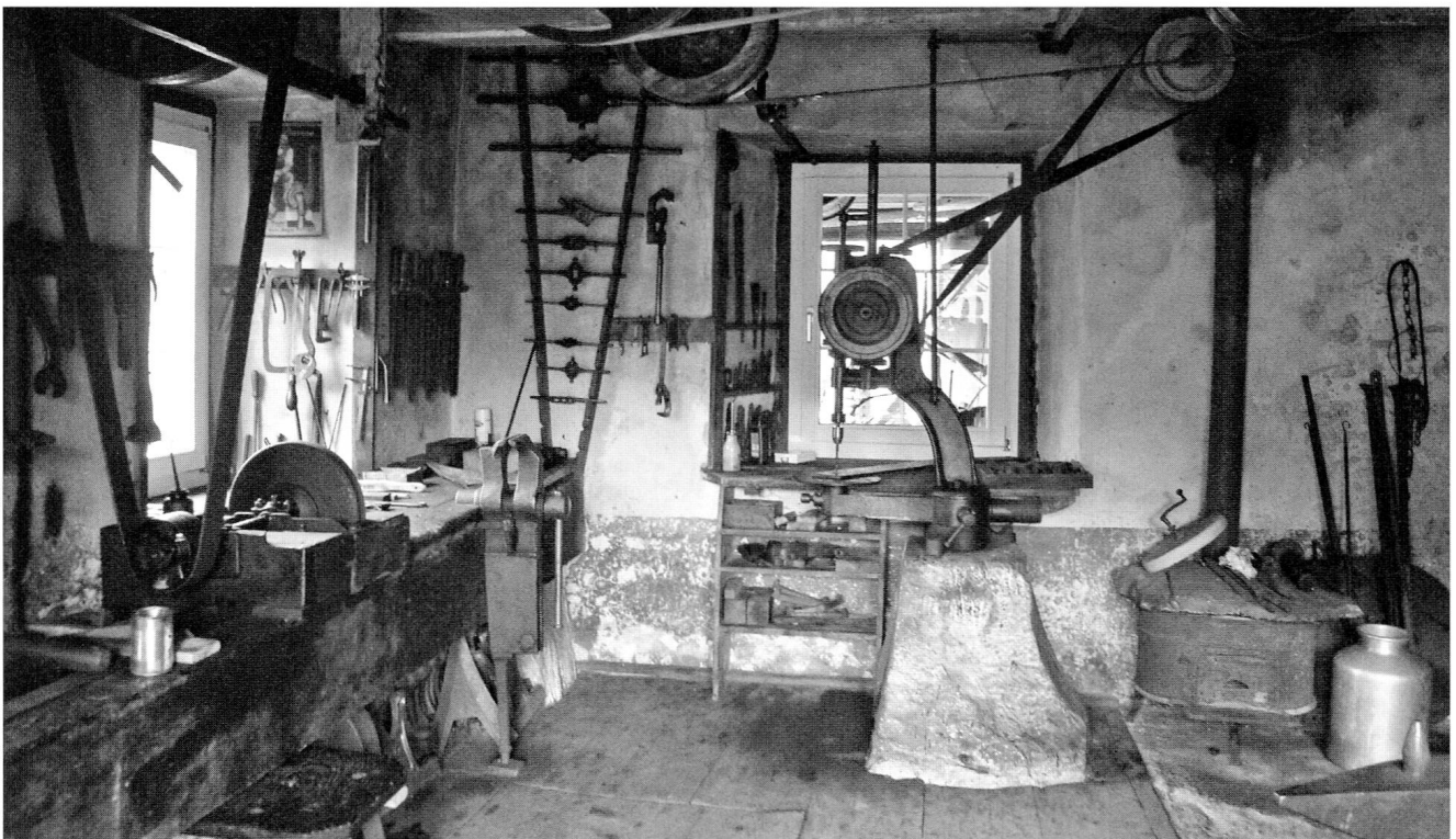
Über die Transmissionsräder werden der Schleifstein und die Bohrmaschine angetrieben. (Foto Silvia Conzett 2012)
