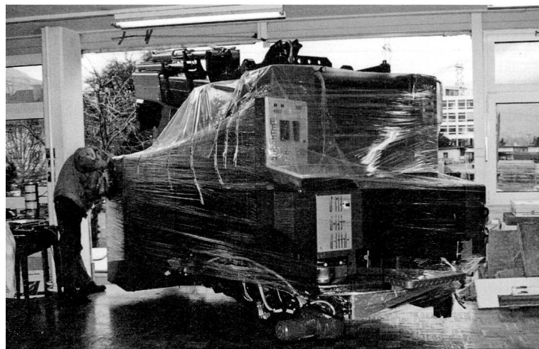
Eine neue Druckmaschine SM 74/2 wird im Jahr 2001 mittels Kranen durchs offene Fenster eingebracht.
