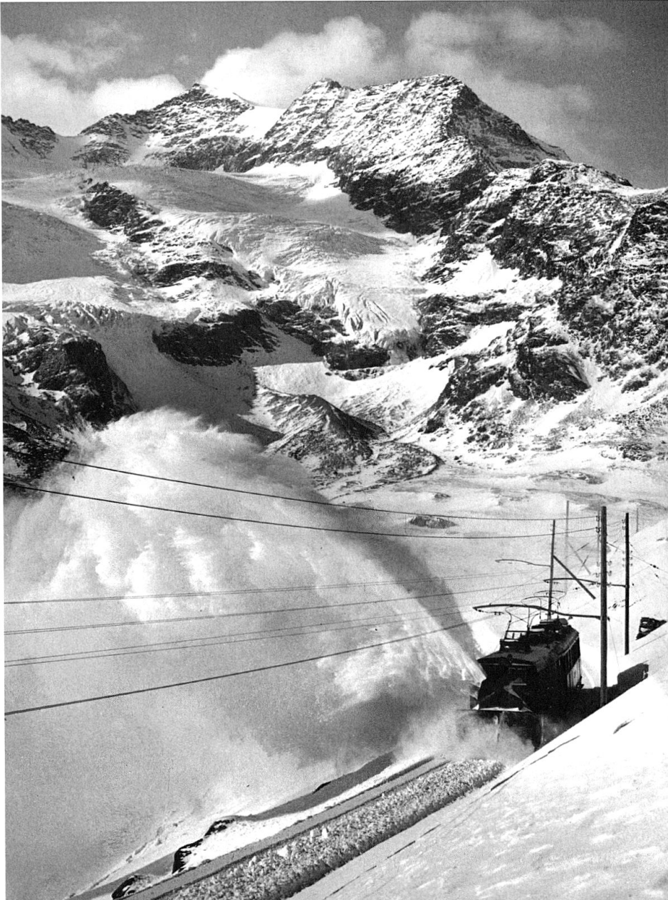
Die erste elektrische Schneeschleuder der RhB von 1943 im Einsatz zwischen Arlas und Ospizio Bernina (RhB).
