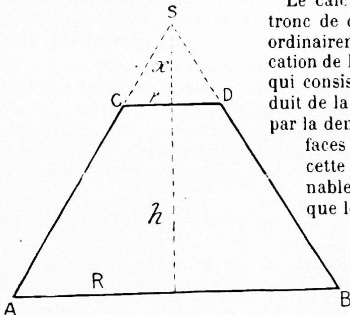
Le calcul du volume du tronc de cône n'est le plus ordinairement que l'application de la règle empirique qui consiste à faire le produit de la hauteur du tronc par la demi-somme des surfaces de ses bases. Or cette règle est abominablement fautive lorsque le tronc de cône a peu de différence avec le cône dont il a été déduit ; à la limite, elle fait le volume du
