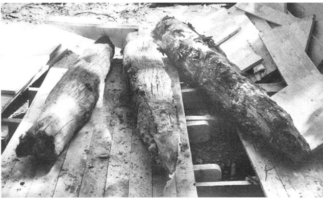
Abb. 4: Die geborgenen Eichenpfähle auf dem Baugelände, Juni 1998.
