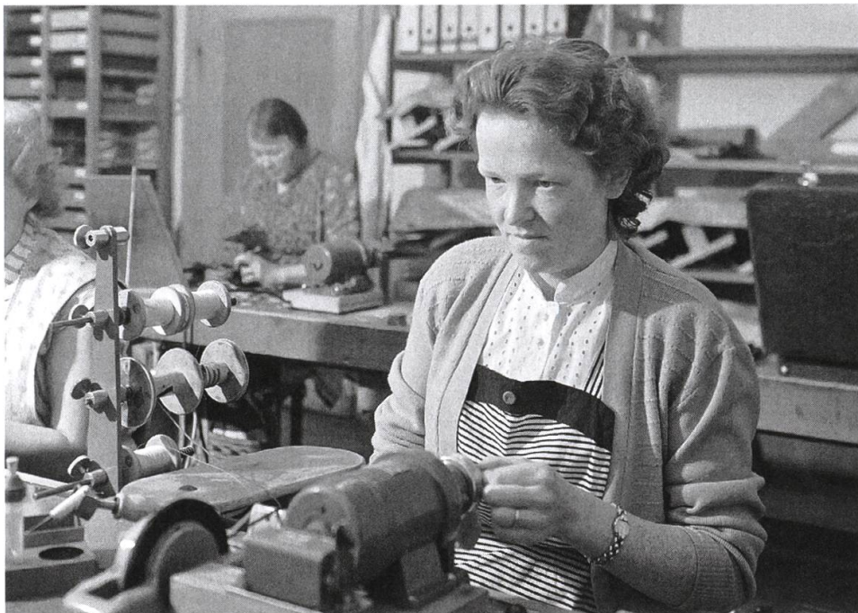
Wickeln von Relaispulen mit der Handwickelmaschine. Auf dem zweiten Bild gut erkennbar sind die typischen dreibeinigen hohen Hocker, die in der Fertigung sehr verbreitet waren.
