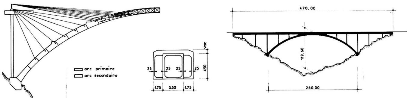
Fig. 19 - Construction du projet du viaduc du MAGNAN
