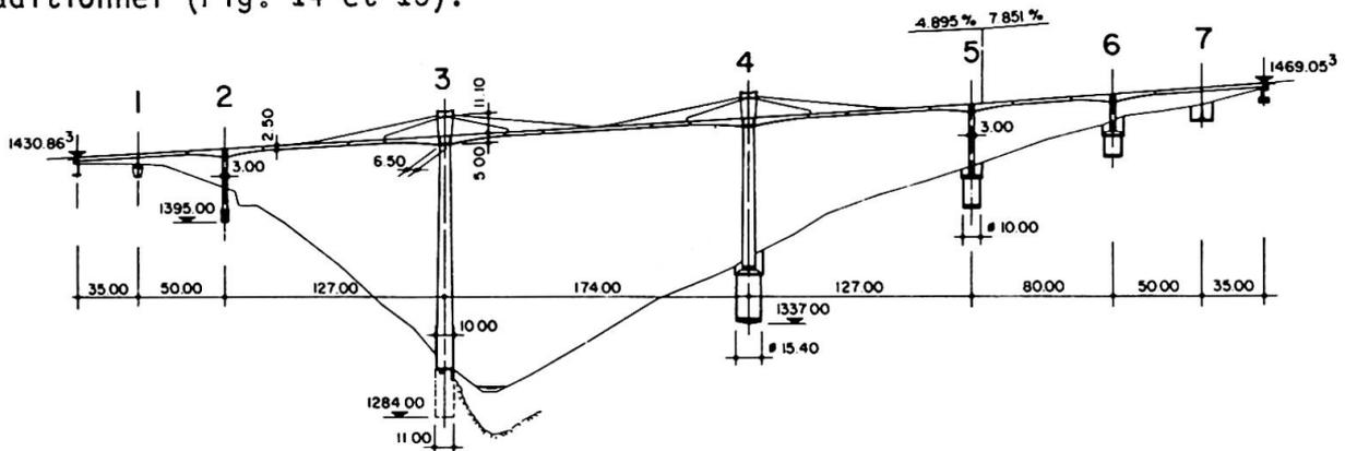
Fig. 14 - Coupe longitudinale du pont sur le GANTER
