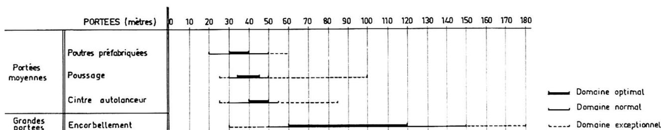
Fig. 1 - Domaine des grands ponts en béton précontraint
