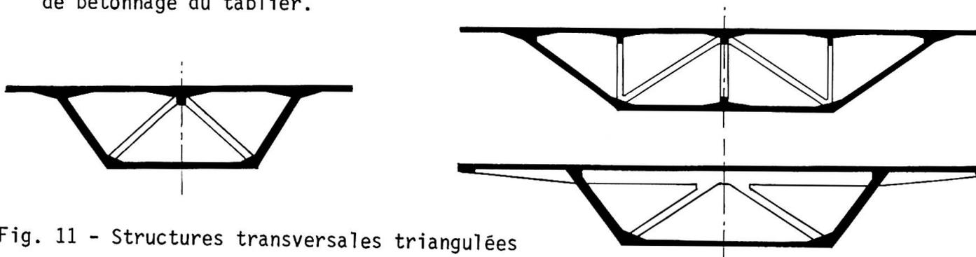
Fig. 11 - Structures transversales triangulées
