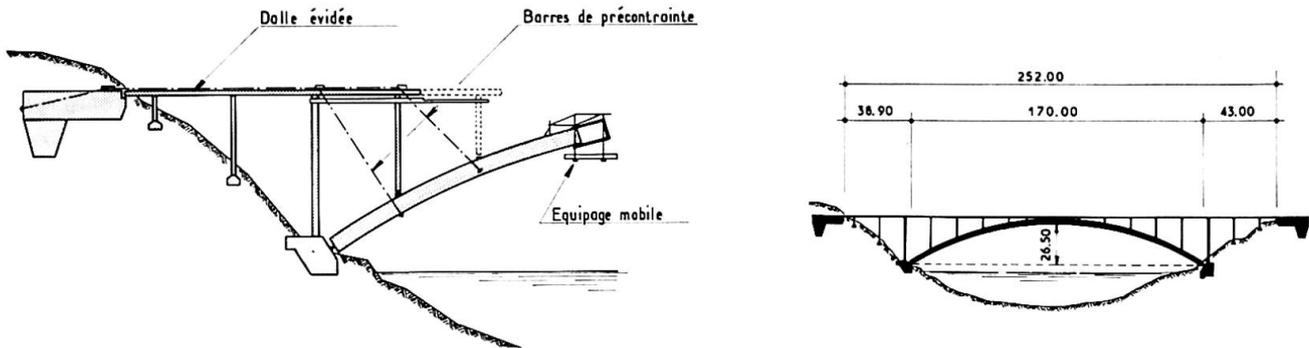
Fig. 21 - Construction du pont de HOKAWAZU (Japon)
