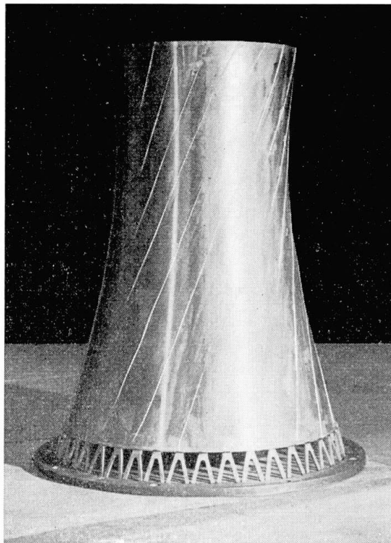
Fig. 6. Modèle avec les nervures obliques dans le sens d'une seule famille des génératrices rectilignes, dont l'épaisseur est de l'ordre de \frac{1}{3} de l'épaisseur de la coque, soit 0,3 mm.
