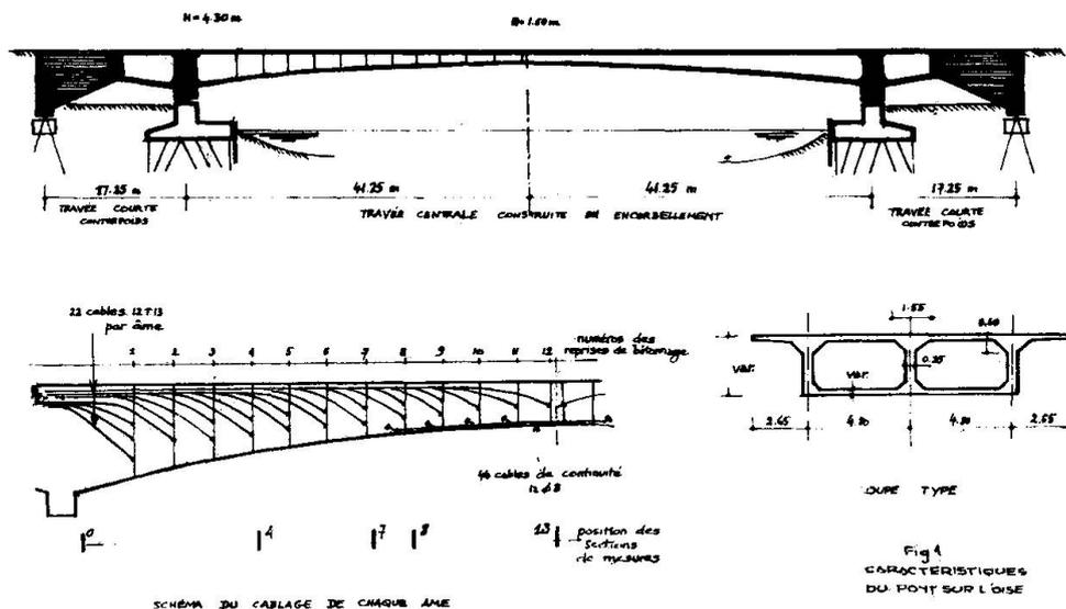
La précontrainte est assurée par deux groupes de câbles. En cours de construction, chaque tronçon d'encorbellement était relié aux parties déjà construites par des câbles STUP 12 T 13. Au moment du clavage des deux consoles, des câbles 12 Ø 8 disposés dans le hourdis inférieur de la zone centrale de l'arche ont été mis en tension, pour assurer la continuité de l'ensemble.
