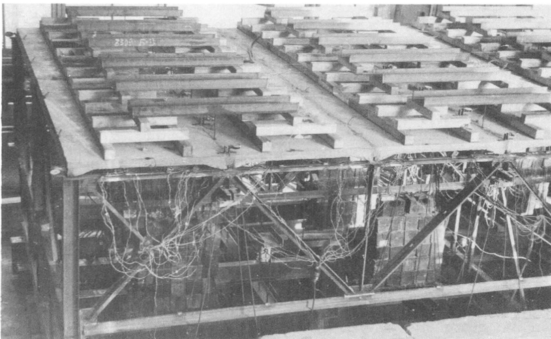
Fig. 4. Versuche mit einem Stahlbetonverbundfragment
