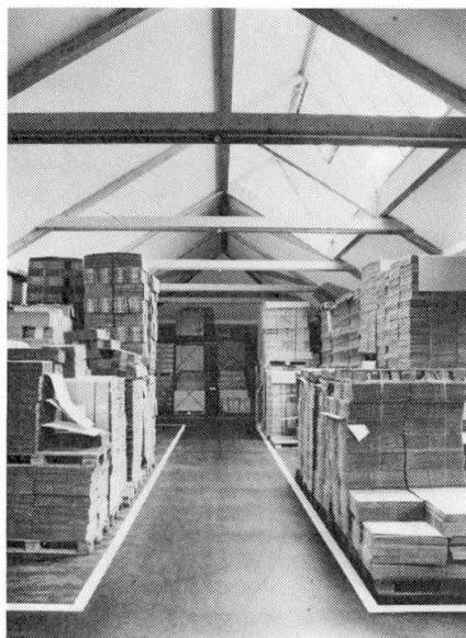
Abb. 3 Geneigte Dächer vergrößern das nutzbare Raumvolumen.
