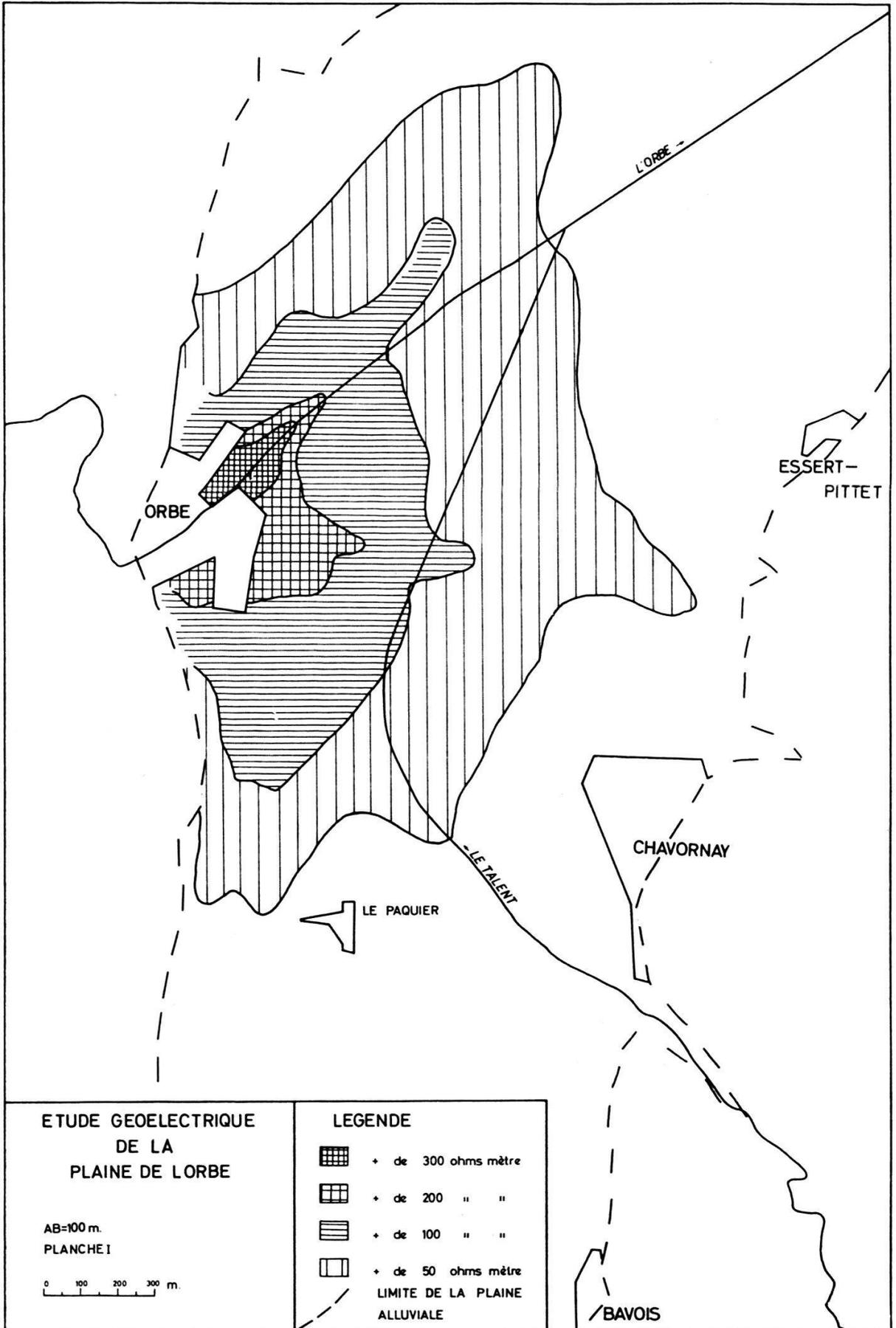
Finalement, nous constatons que la résistivité des diverses formations géologiques intéresse tout particulièrement l'hydrologue, puisque cette résistivité varie avec les propriétés qui font d'une roche un bon ou un mauvais réservoir.
