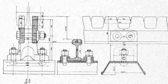
Les lames de la crémaillère, ainsi que leurs supports fixés au milieu de chaque traverse, ne diffèrent du type courant Abt que par leurs dimensions; chaque lame a une longueur de 1<sup>m</sup>,800 et une épaisseur de 25 mm., le point supérieur de la lame est à 104 mm. au-dessus du niveau du rail.
