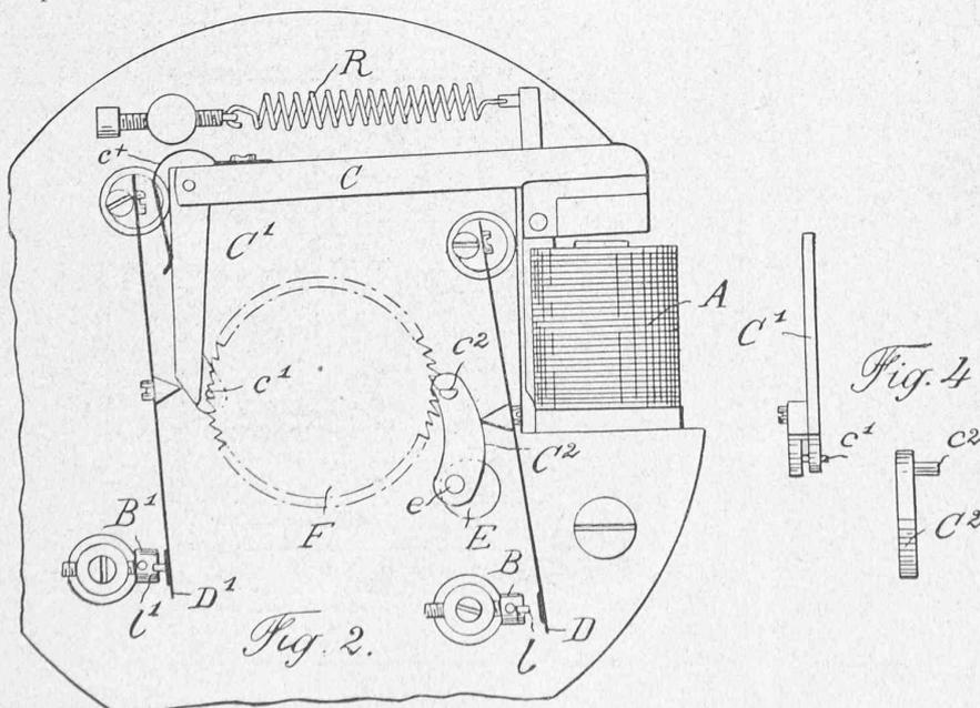
Dès que l'amplitude des oscillations du balancier est descendue au-dessous d'une valeur déterminée, cet électro-aimant entrant en jeu attire l'armature en communiquant au système une impulsion nouvelle. Cette prise de courant au moment voulu s'obtient par différents procédés.
