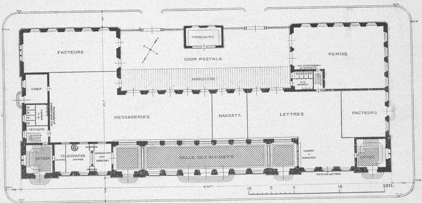
Plan schématique d'un rez-de-chaussée pour l'Hôtel des postes et des télégraphes à La Chaux-de-Fonds.
