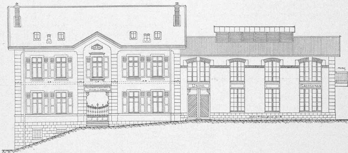
Fig. 16. — Bâtiment d'administration et usine des Tramways lausannois à la rue St-Martin, pendant la 1 re période d'exploitation (1895-1903). Façade Sud. — Echelle : 1 : 50.
