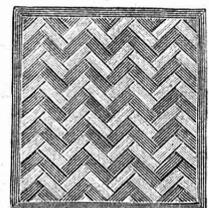
Vissé sur faux ou vieux plancher, rendu posé au bain de mortier de silicate de soude sur béton en ciment Portland, ou béton en scorie, selon tous les dessins: carré, octogones, etc., en quatre couleurs et en forme de fougères (bâtons rompus).
